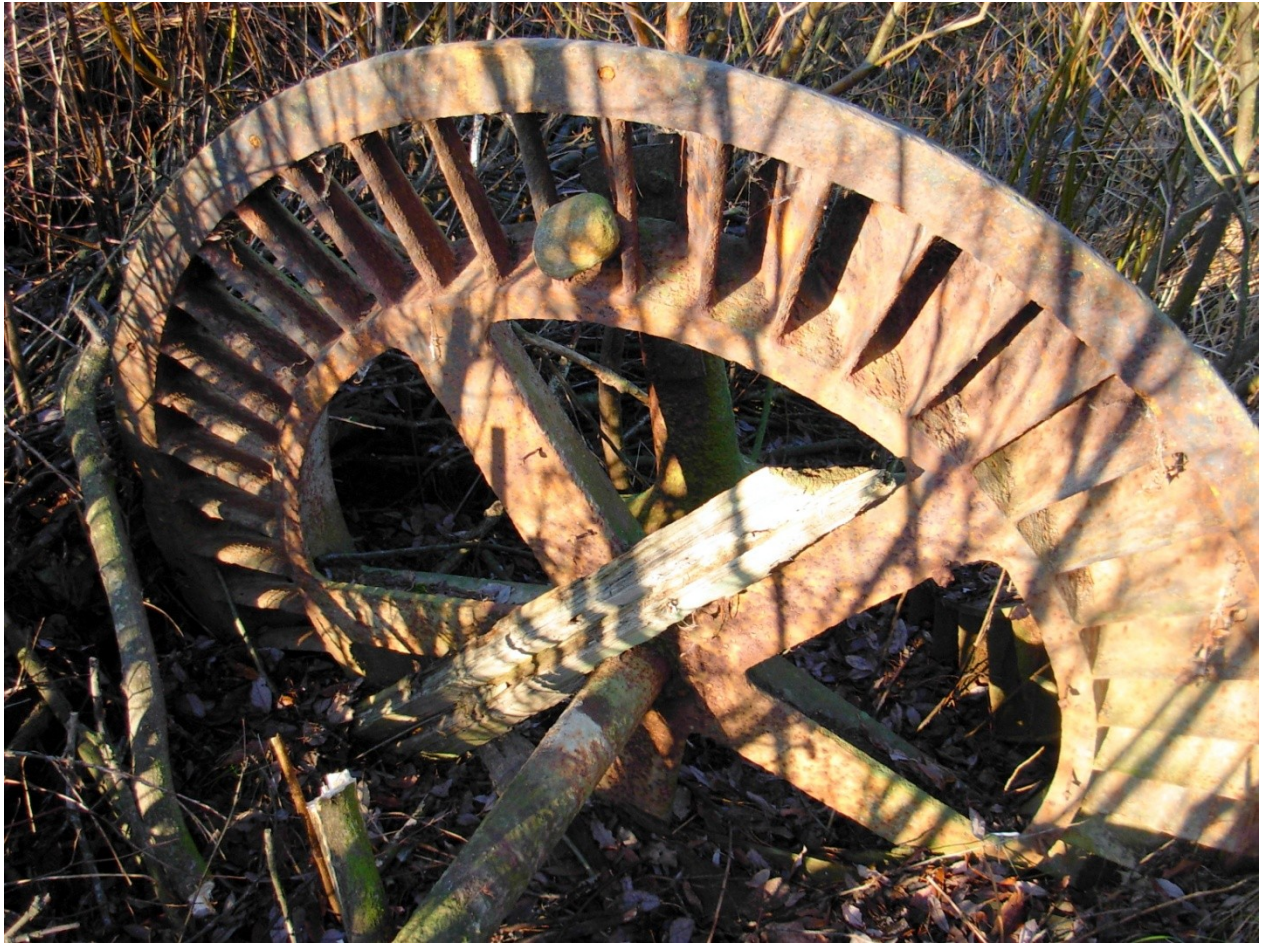
Ledskovelhjulet, eller rättare sagt ledskovelkransen, till turbinen vid Nybro kvarn. Öppningen där de fem ekrarna finns, täcktes med ett lock gjort av bräder fästade med skruvar i ledskovelhjulet. Några av skruvarna syns på bilden.
